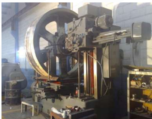
Reconstrucción de volante de quebradora
