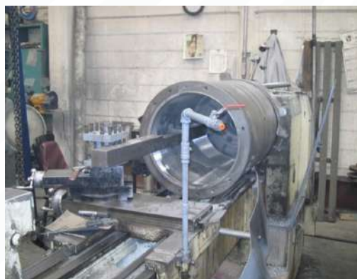
Reconstrucción de chumaceras para malacate
