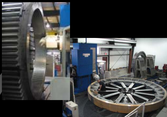
Fresado de engranajes en 5 ejes hasta 8 m
