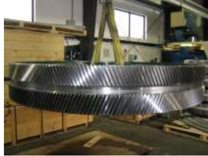
Engranaje de dragalina de doble hélice rectificado según AGMA 12
