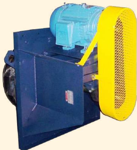
Los hay disponibles con carcasa para distribución de aire en ductos. Se construyen en placa gruesa de acero con chumaceras bipartidas para trabajo pesado, en 14 tamaños diferentes para manejar volúmenes de hasta 56,000 PCM y presiones de hasta 8.0 pulgadas columna de agua.
