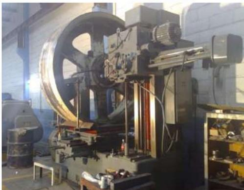
*Reconstrucción de volante de quebradora*
