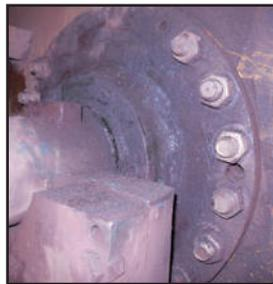
Volante de péndulo instalado con tuercas normales
